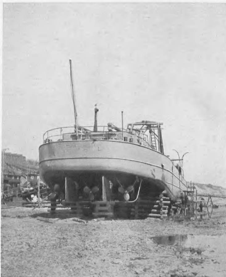
Наливное судно «Вандалъ» съ двигателями Дизеля.
