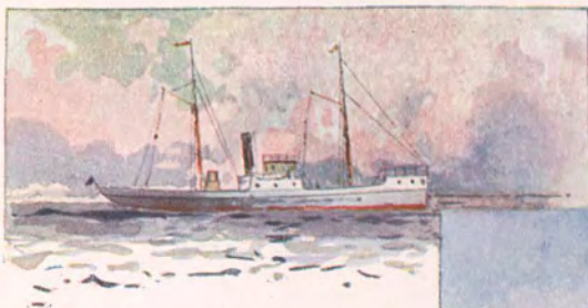
1878 годъ. «ЗОРОАСТРЪ». 1-й въ міръ наливной пароходъ. Длина 136,5'; ширина 27,5'. Емкость—15.000 пудовъ.
