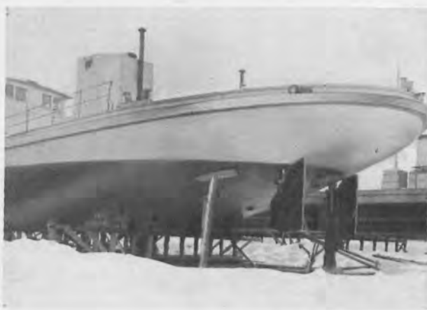
Желѣзная баржа Товарищества новаго типа съ двумя балансирными рулями.
