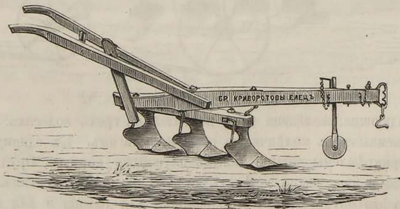
Фиг. 51. Трехкорпусный плужокъ-запашникъ.
