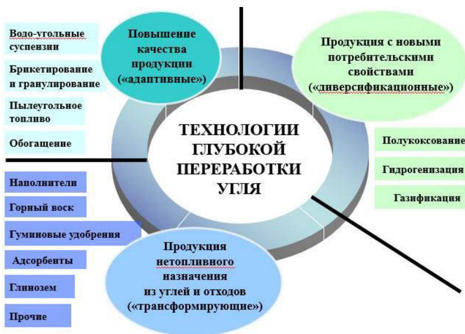
Рис. 7.8. Классификация технологий комплексной переработки углей
