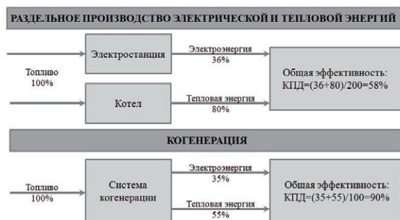
Рис. 3.3.1. Преимущество комбинированной выработки электроэнергии и тепловой энергии над раздельной
