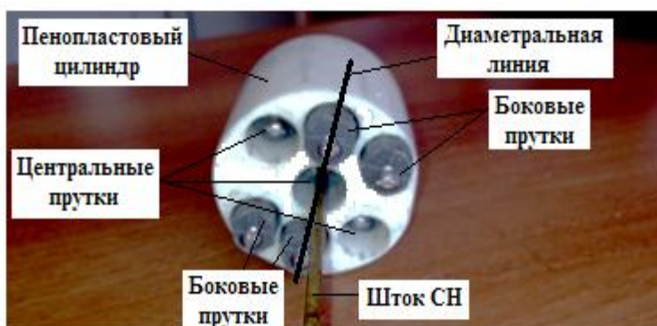
Рис. 5. Фото согласованной нагрузки с задней стороны.
