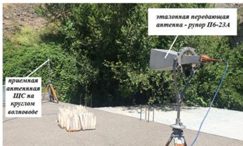
Рис. 11. Фото измерительной площадки с установленными на ней антеннами.
