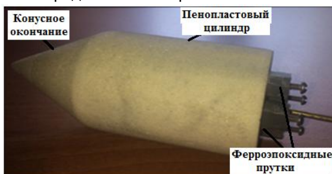
Рис. 4. Фото согласованной нагрузки.
