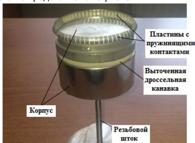
Рис. 6. Фото короткозамыкателя.
