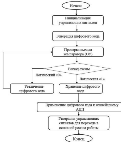
Рис. 6. Блок-схема коррекции смещения напряжения компаратора
