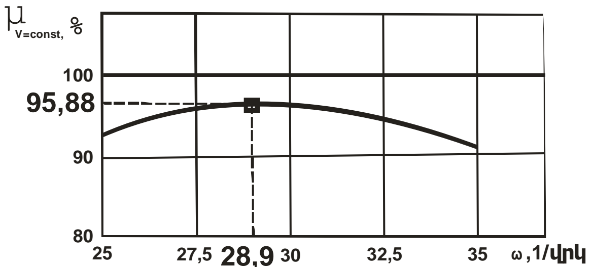
Նկ. 4.9. Պլաները հողից ջրկման աստիճանի փոփոխություները՝ կախված ռոտացիոն կոշտամանրիչ-փոխակրիչի պտտման անկյունային արագությունից, մեքենայի շարժման արագության V = 0,96 մ/վրկ օպտիմալ արժեքի դեպքում:
