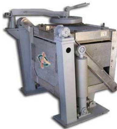
Նկ. 1.7. ՄՍՏ տեսակի ինդուկցիոն տեղակայանքի տիգելային վառարանի ընդհանուր տեսքը
