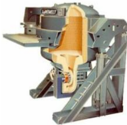
Նկ. 1.12. Խուղակային ինդուկցիոն վառարանի ընդհանուր տեսքը
