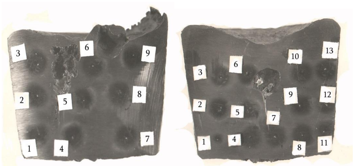
Նկ. 6.1. Նմուշների նկարները վերլուծությունից հետո Այսպիսով արտադրական փորձարկումները ցույց են տալիս, որ նպատակահարմար է պողպատների լեգիրումը մոլիբդենի
