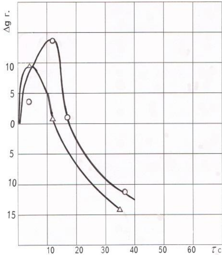
Նկ 5.13. մոլիբդենի երկսիլիցիդի նմուշների զանգվածների փոփոխությունը՝ հալույթում դրանց ընկղման ժամանակից
