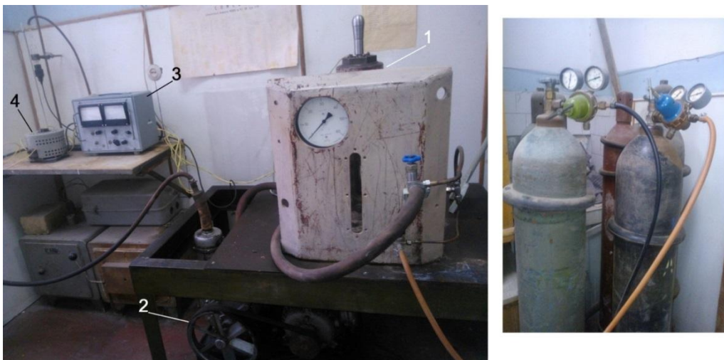
Նկ. 2.8. Հաստատուն ճնշման լաբորատոր ԲԻՍ ռեակտորի սխեման. 1- ԲԻՍ ռեակտոր, 2 - BH – 2ՄԴ տիպի վակուումային պոմպ, 3 – BNT-2 տիպի վակուումմետր, 4 - լաբորատոր ավտոտրանսֆորմատոր
