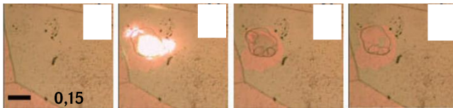
Նկ. 5. Ներկանյութով հարստացրած խիրավ ՀԲ-ում լազերային ճառագայթման սպեկտրները (ա և ե), և միկրոսկոպի միջոցով ստացված կառուցվածքային փոփոխությունների պատկերը: Մղման փնջի հաճախությունը 12,5 Հց է, իսկ իմպուլսների էներգիան՝ ա, բ, գ, դ դեպքում 28 մկՋ/իմպուլս, ե, գ, է, ը, թ դեպքում 336 մկՋ/իմպուլս: բ և գ նկարներում ցույց է տրված նմուշում ԽՀԲ-ի կառուցվածքը սկզբնական վիճակում, դ և ը նկարներում՝ մղման փունջն անջատելուց անմիջապես հետո
