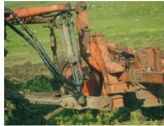
Նկ.34. Լանջերում հողամշակ մեքենաների ընթացքի խորության համաչափության և ագրեգատի ուղղույթի կայունության կարգավորման հարմարանք
