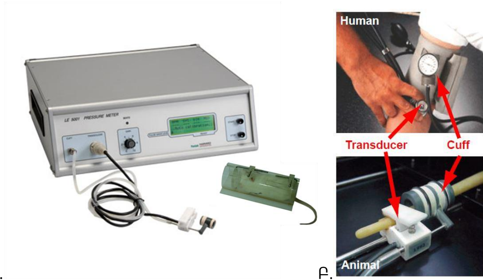
Նկար 2.4. «Tail-cuff» ոչ ինվազիվ մեթոդով առնետների զարկերակային ճնշման որոշման սարքավորումը (Ա) և աշխատանքի սկզբունքը (Բ):
