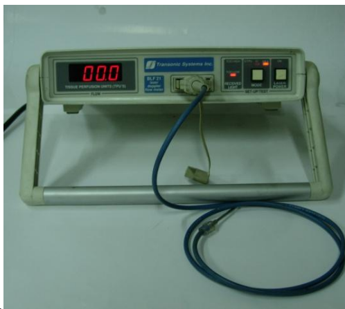
Նկար 2.3. BLF-21 դոպլերային հոսքաչափը N տեսակի ասեղաձև գրանցիչով (Ա.) և առնետների անշարժացման համար նախատեսված ստերետոպասիկ կաղապարը (Բ.)
