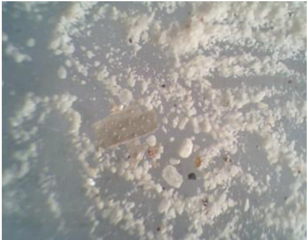
Փորձ անմուշ №2, բյուրեղային կալցիտով և օրգանոգեն մնացորդներով կրաքարի մակատեսքը (խոշոր հատիկաչափ), բին. մանր. x 25
