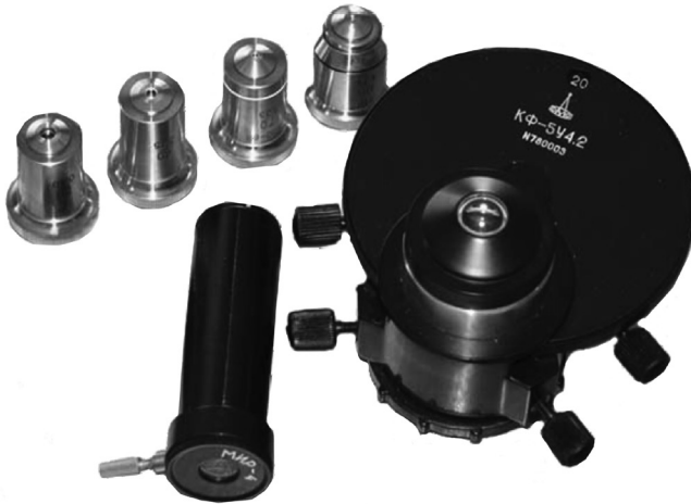
Նկար 27. Փուլացայտերանգային հարմարանքի օպտիկական համակարգը:
