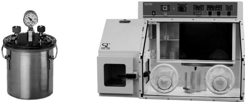
Նկար 16. Անատերոբ մանրէների աճեցման համար նախատեսված անատերոստատ (ձախից) և անատերոբ խցիկ (աջից):
