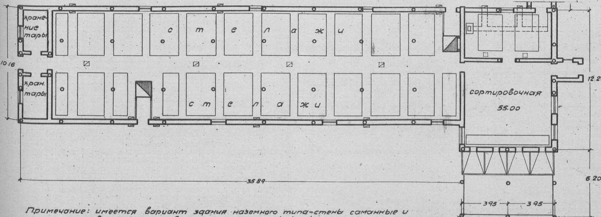
Примечание: имеется вариант здания наземного типа - стены саманные и вариант заглубленного типа - стены каркасные.
