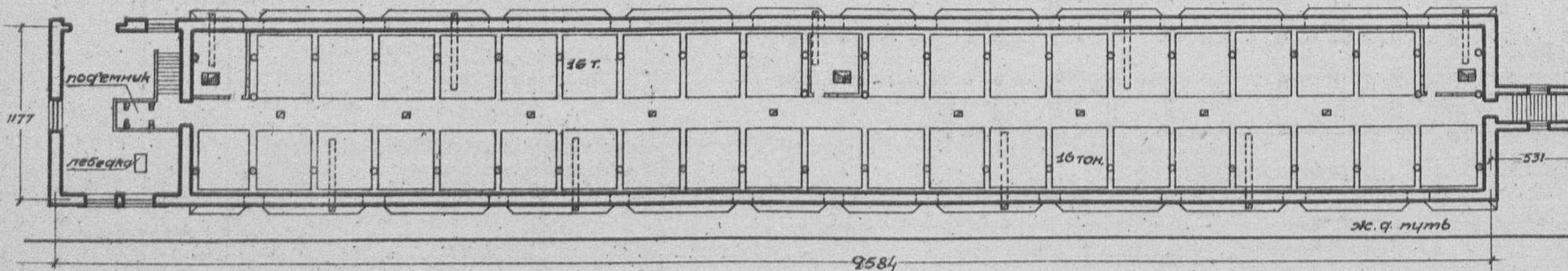
Примечание: в проекте имеются варианты: хранилище пристанционного типа с каркасными стенами и глубинного типа с каркасными стенами и каменными стенами.
