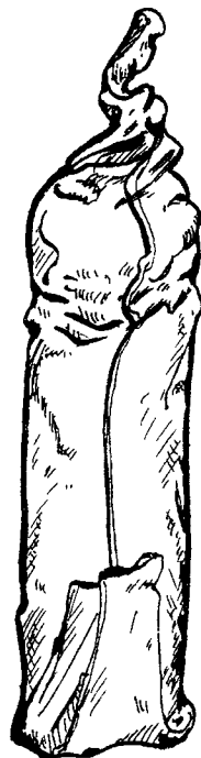
Бумажный патрон с пулей и порохом: в разрезе; общий вид.
