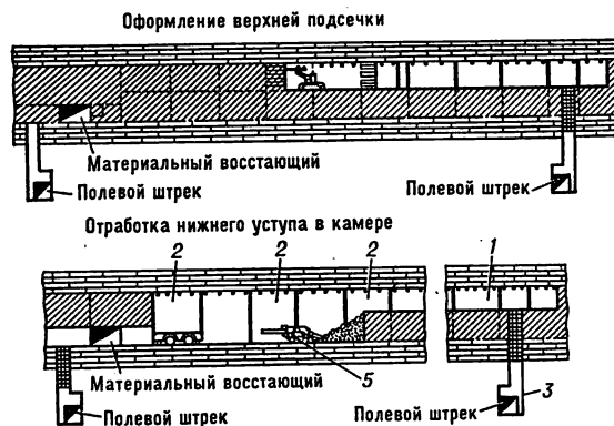
Рис. 2. Второй комплекс: 1 — камеры; 2 — опорные целики; 3 — рудоспуски; 4 — буровая каретка; 5 — погрузочная машина.
