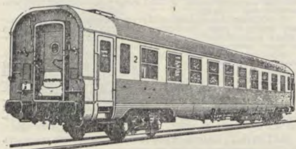
Рис. 2. Пассажирский вагон длиной 25 м французских железных дорог.
