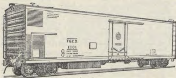
Рис. 1. Изотермический вагон с индивидуальным машинным охлаждением и полностью автоматизированным управлением.
