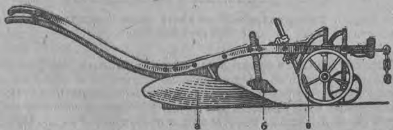
Рис. 37. Однокорпусный английский плуг с укороченным винтовым отвалом (среднего типа). Впереди главного корпуса (а) помещается скимкольтер (б) и перед ним нож (в).
