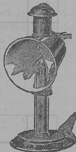
Рис. 2. Подсвѣчникъ съ рефлекторомъ для лектора.
